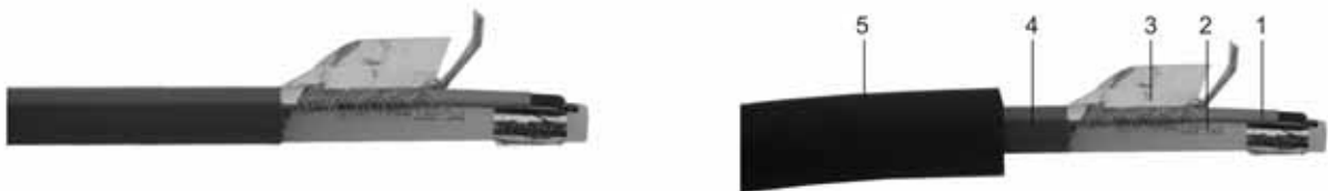
1、屏蔽型自限式电热带； 2、PE、PP-R、PEX、PE-R、PE-RT管； 3、阻氧、传热、铝塑复合带； 4、防水、阻燃、PVC组合 5、橡塑保温管。
